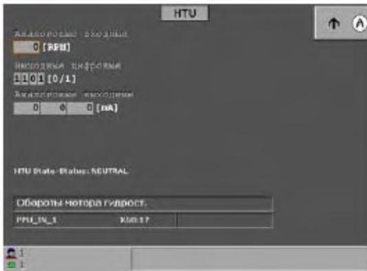
**HTU:** Стояночный тормоз нужно квитировать, чтобы все входные сигналы HTU были в использовании (F,N,R кнопки). Аналоговые входные цепи могут показывать состояние Hi ja Lo. Аналоговые выходные цепи (PWM) могут показывать короткие замыкания и обрывы. HTU State-Status указывает, в каком состоянии HTU в данный момент находится: "СТОП", "НЕЙТРАЛЬ", "ВПЕРЕД", "НАЗАД", "ДВИЖЕНИЕ НАЗАД", "СВОБОДНОЕ КАЧЕНИЕ", "ПОТЕРЯ НЕЙТРАЛИ" или "ДВИГАТЕЛЬ РАБОТАЕТ".
