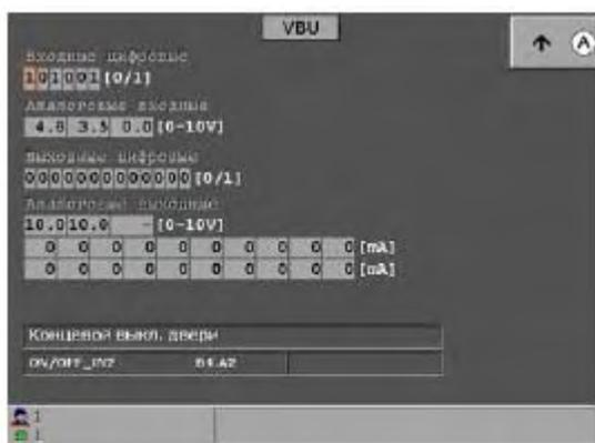
**VBU:** PWM-выходы и выходы цифровых сигналов регистрируют короткие замыкания и обрывы.
